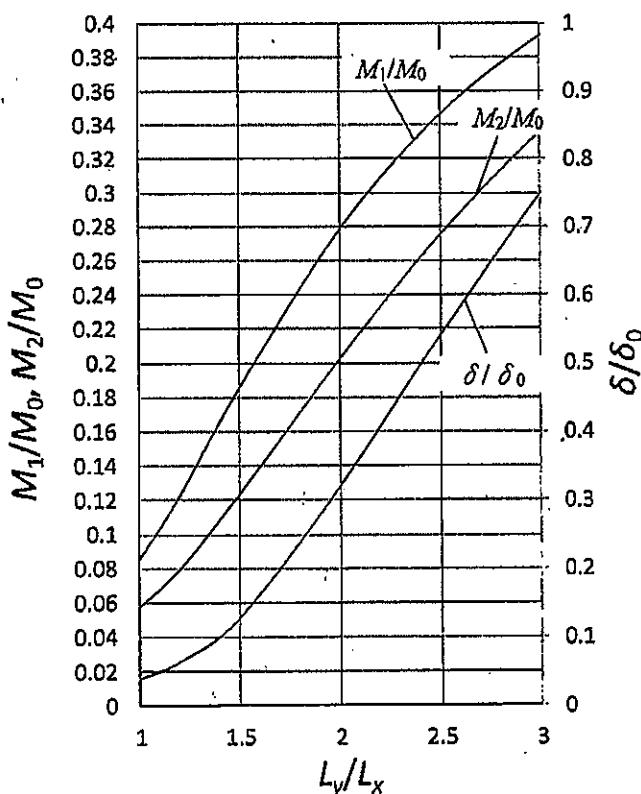
図4 3辺固定1辺自由の板に等分布荷重が作用するときの曲げモーメントとたわみ
