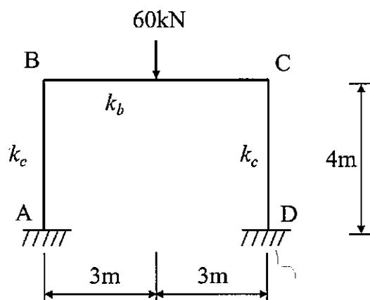
図2 鉛直荷重が作用するラーメン
