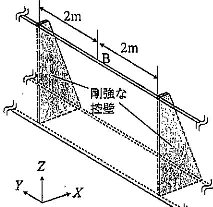
図3 控壁で補強された壁
